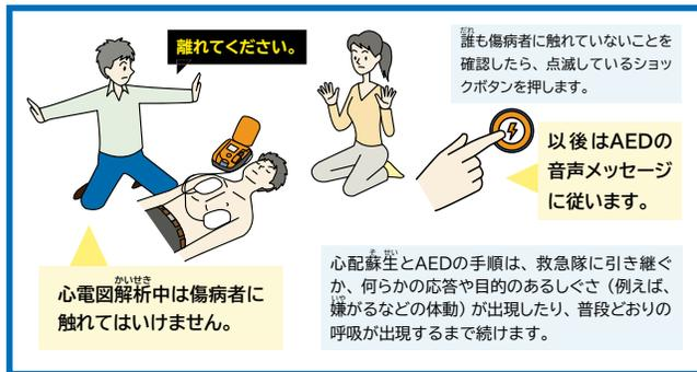
電気ショックが必要かどうかは、AEDが判断します。点滅しているショックボタンを押します。(音声メッセージが流れた後に自動的に電気ショックが実施されるショックボタンのない機種もあります。)
